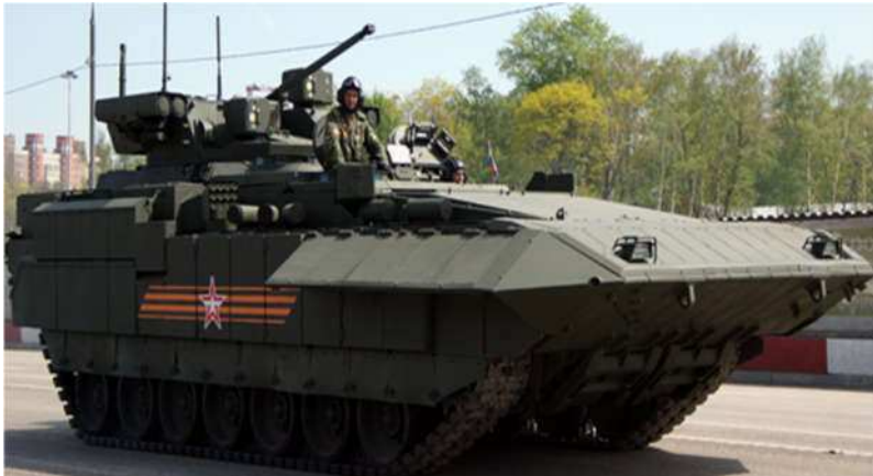
Рис. 1.3 – Важка БМП Т-15 на платформі “Армата”
