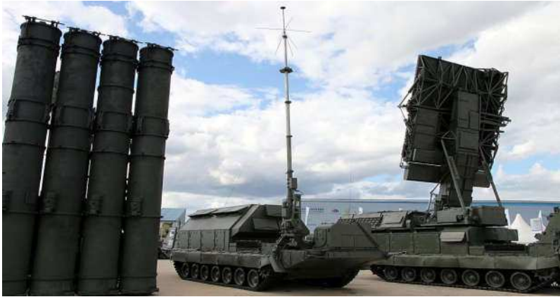
Рис. 1.114 – Елементи ЗРС С-300В (ПУ 9А83 з піднятими ТПК, командний пункт 9С457, РЛС кругового огляду 9С15М)
