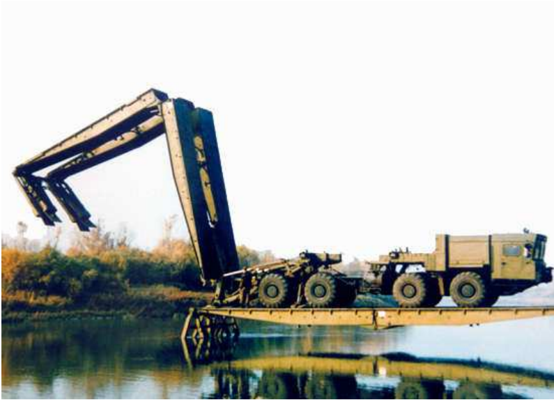
Рис. 1.154 – Важкий механізований міст ТММ-6 “Гусениця-2”
