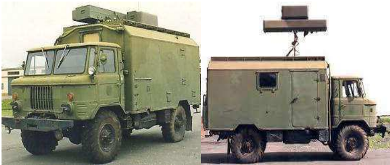
Рис. 6.50 – Станція РТР 1РЛ234 “Вектор”
