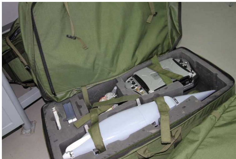
Рис. 1.136 – Безпілотний авіаційний комплекс “Застава”
