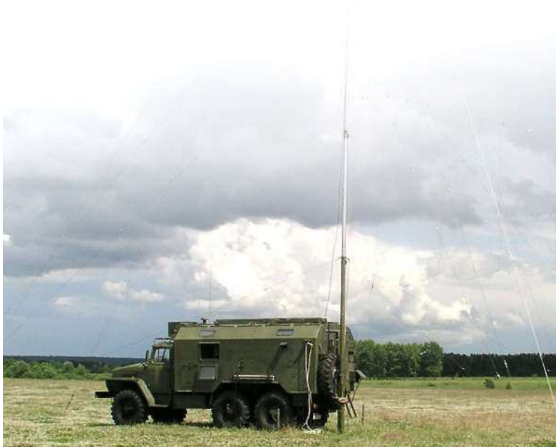
Рис. 6.4 – АСП КХ радіозв'язку Р-378А
