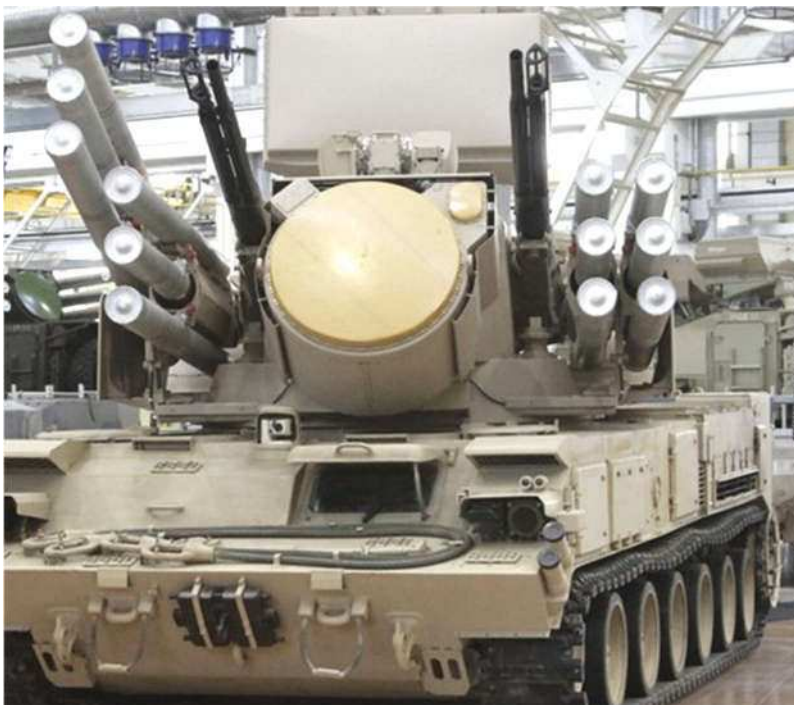
Рис. 2.174 – БМ 72В6Е на шасі ГМ-352М1Е ЗРГК “Панцирь-С1”
