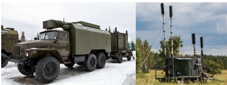
Рис. 6.24 – Пункт управління Р-330КМА зі складу автоматизованого комплексу “Диабазол” з АСП Р-330Ж
