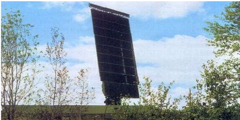
Рис. 2.184 – РЛС “Противник-Г” у розгорнутому стані
