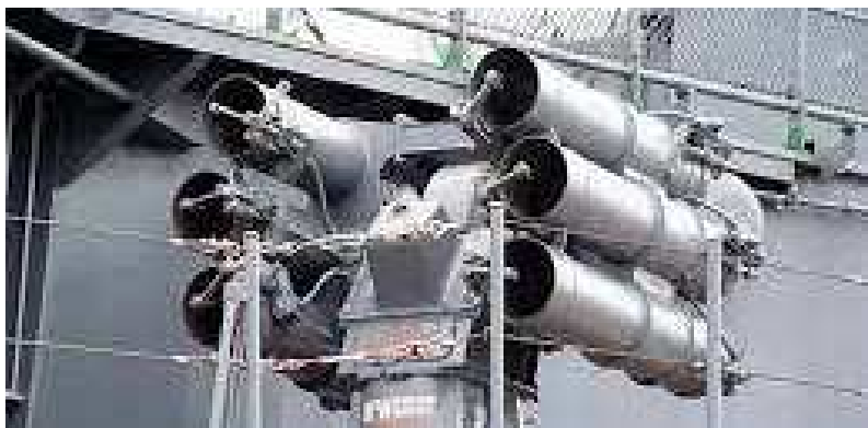
Рис. 3.55 – Реактивно-бомбова установка РБУ-1000 “Смерч-3”
