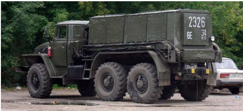
Рис. 2.114 – Зовнішній вигляд аеродромного рухомого електроагрегату АПА-100
