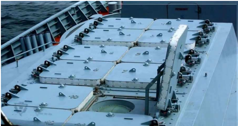
Рис. 3.69 – Пускові пристрої ЗКР “Редут”
