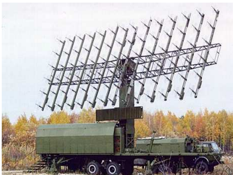
Рис. 2.190 – РЛС “Небо-СВУ” в розгорнутому стані
