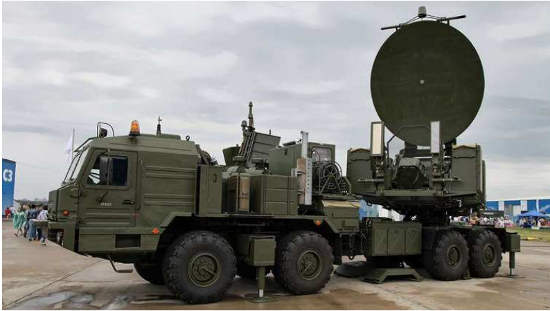
Рис. 6.18 – Станція РЕП 1Л269 “Красуха-2”
