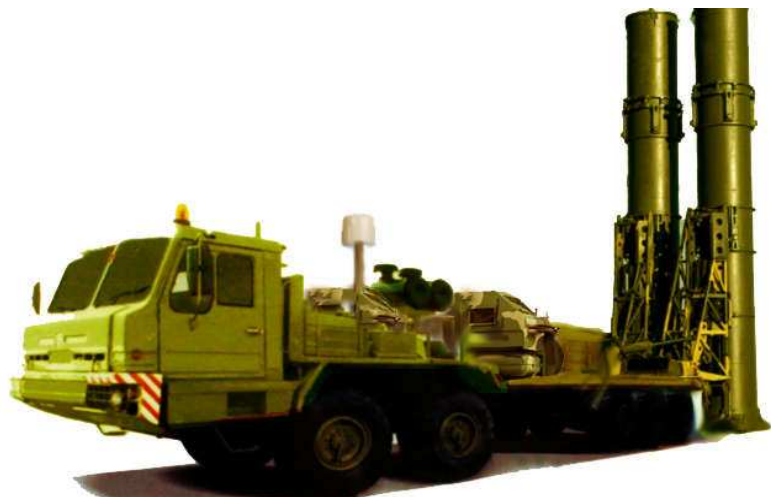
Рис. 2.154 – ПУ 51П6М з ракетами 40Н6М в ТПК
