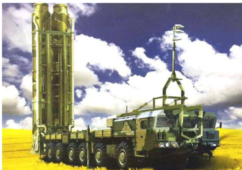
Рис. 2.155 – ПУ 77П6 із протиракетами 77Н6 в ТПК
