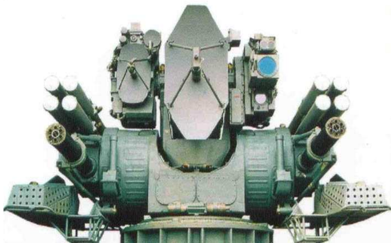
Рис. 3.58 – Зенітний ракетно-артилерійський комплекс “Кортик-М”
