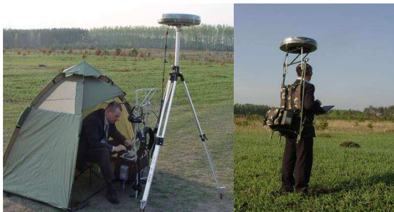
Рис. 6.37 – Переносні варіанти радіопеленгатора “Артикул-Н1”
