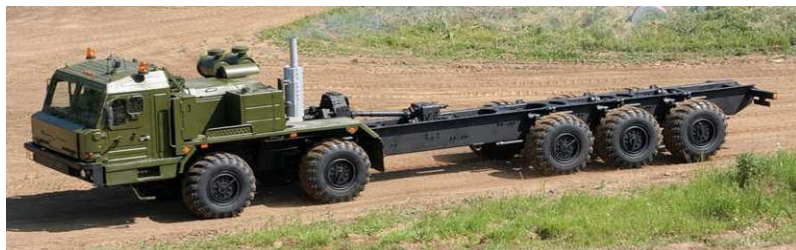
Рис. 2.156 – Шасі БА3-69096 для розміщення засобів ЗРС С-500
