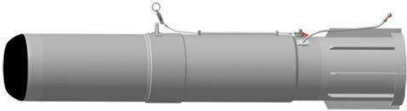
Рис. 2.93 – Протичовнова коригуєма авіаційна бомба “Загон-1” (СЗВ)
