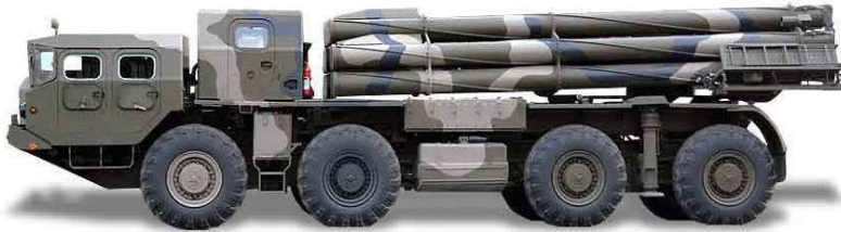
Рис. 1.51 – Бойова машина БМ-30 РСЗВ “Смерч”
