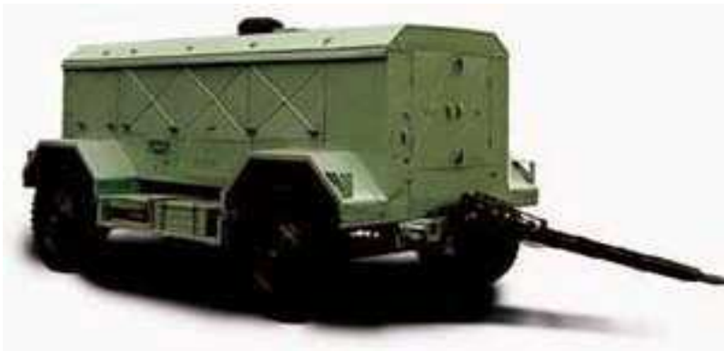
Рис. 2.117 – Зовнішній вигляд уніфікованої компресорної станції УКС-400
