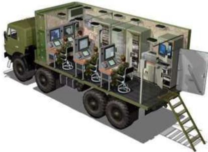
Рис. 2.198 – Зовнішній вигляд КЗА “Фундамент-Э” у рухомому варіанті виконання: а) – зовнішній вигляд; б) – місце оператора
