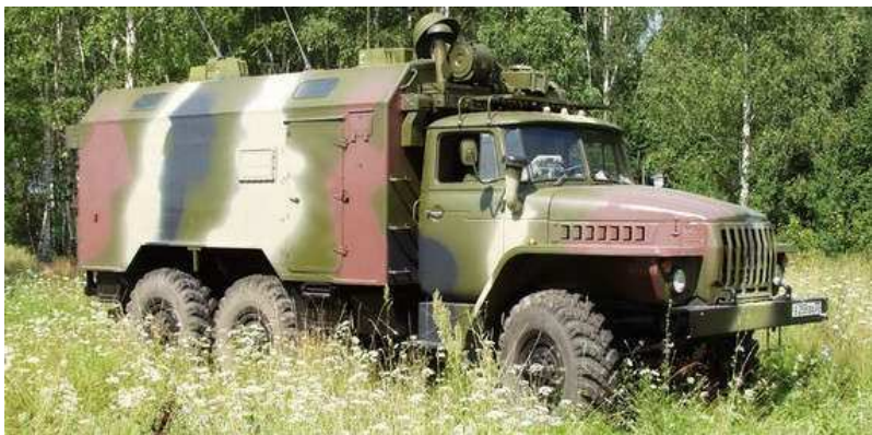
Рис. 1.90 – Командно-штабна машина 1В153 комплексу 1В126
