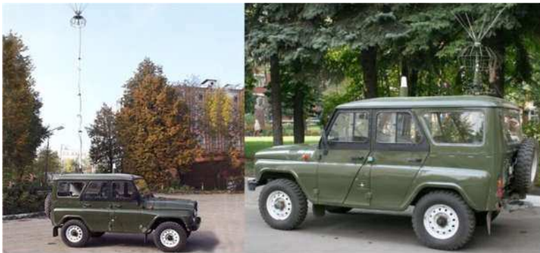
Рис. 2.106 – Радіостанція Р-840М: а) у розгорнутому; б) у похідному стані
