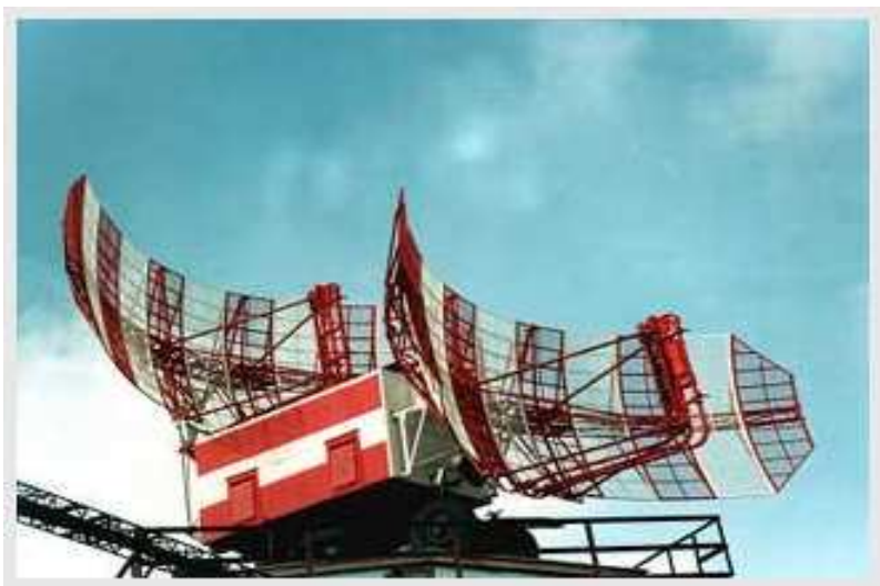
Рис. 2.186 – Приемально-передавальна кабіна РЛС 1Л118М “Ли́ра-1”
