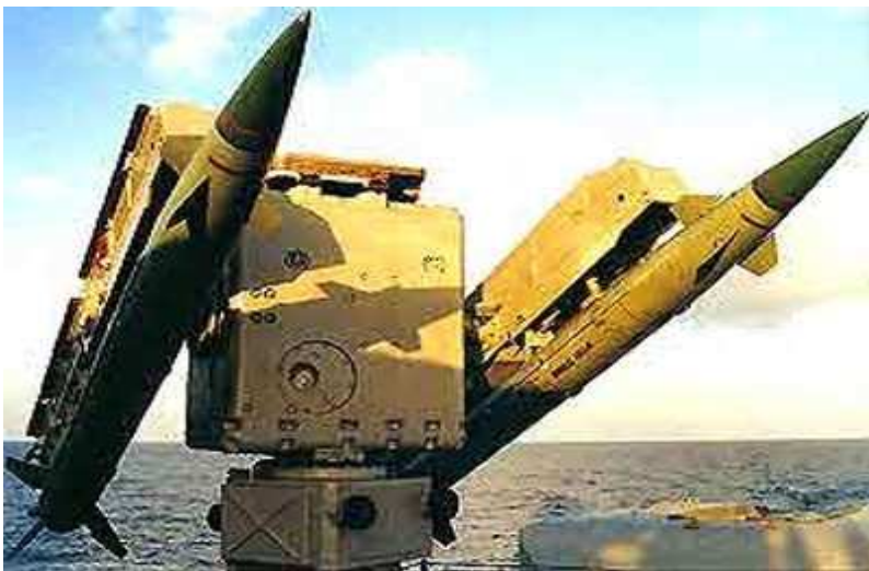
Рис. 3.67 – Пусковий пристрій ЗРК “Оса-М” з двома ЗКР 9М33
