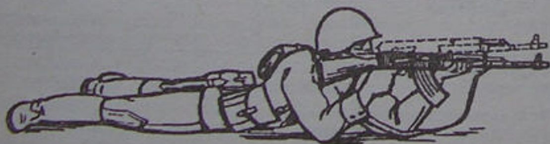
Мал. 90. Підкидання дулової частини ствола зброї догори при пострілі внаслідок відбою
