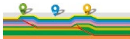
Fig. 6.44. Schemat typowej struktury nasunięcia, na którym pokazano nasunięcie czołowe i powstawanie kolejnej skiby
