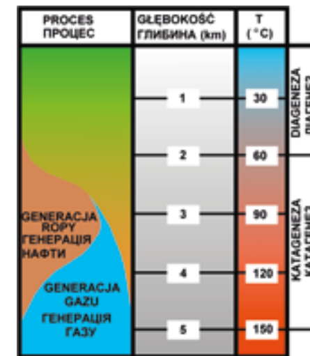
Fig. 4.29. Schemat warunków powstawania ropy naftowej (na podstawie Tissot & Welte, 1984)
